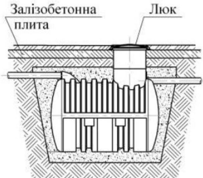
*Установка резервуару при високому рівні ґрунтових вод*
